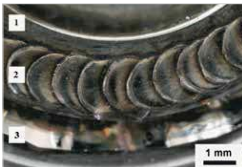
Zväčšený detail zvaru na povrchu krycieho krúžku (1 - krycí krúžok, 2 - zvar, 3 - fólia HAVAR®) Zdroj: Ing. Jaroslav Bruncko, PhD.
